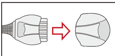
首先将温度控制器与产品的连接器相连接，然后将电源插头连接到插座上。
