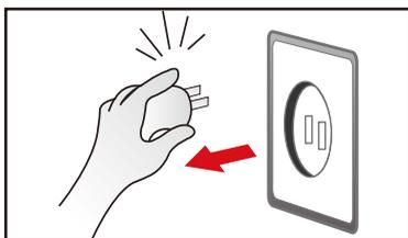
停止使用时，先关闭电源按键，拔掉插头，然后断开温控器与产品的连接器。
